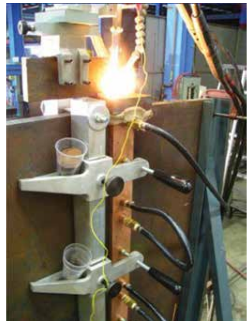
Modern electroslag welding: ESW-NG.
